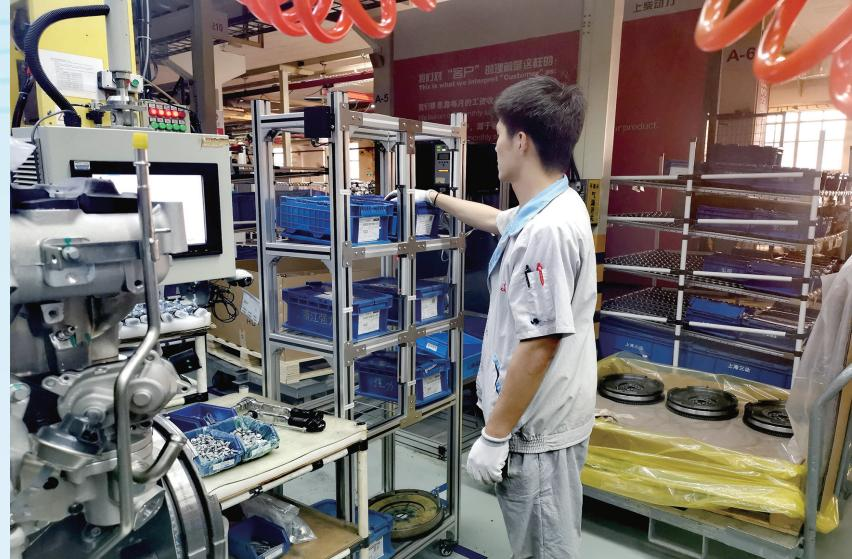
改进前，料架移动到其他岗位非常麻烦，需要设备供应商进行移位和线路的布局安装。改进后的料架下方还配有带锁万向轮，只需操作人员将料架直接推至相应岗位，工艺师再调整系统数据即可。按照每年每组料架
