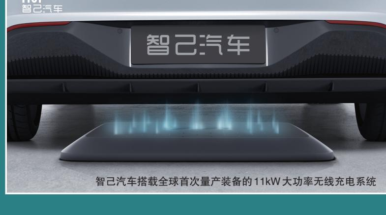
智己汽车搭载全球首次量产装备的11kW大功率无线充电系统
