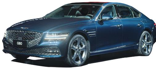
捷尼赛思G80搭载了2.5T涡轮增压汽油发动机，可实现422Nm的最大扭矩。安全方面，全车配备10个安全气囊，并特别设计了主副驾驶座椅之间的中央侧气囊，为前排驾乘人员提供更加全面的碰撞保护。
