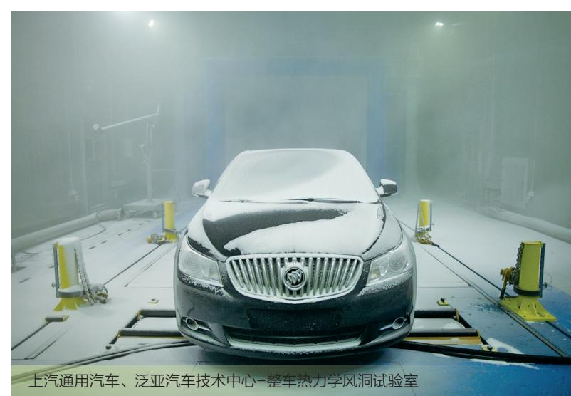
上汽通用汽车、泛亚汽车技术中心—整车热力学风洞试验室
