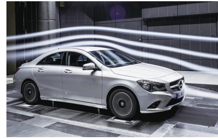
示，汽车的外形和车身比例对空气阻力的影响占40%；车轮和车轮所在空间（车轮室）对空气阻力的影响为30%；车身底部带来的风阻占20%；空气进入车内造成的风阻占10%。
