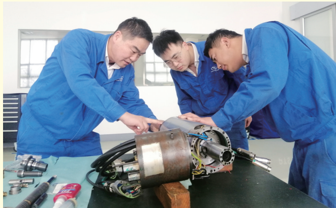
攻坚小组成员研究分析主轴前端锥孔精度
