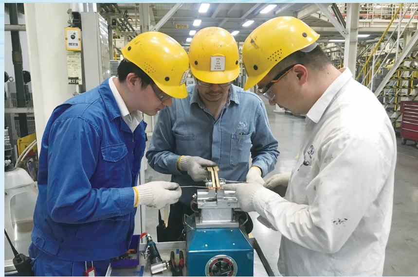
确保焊丝对接的齐整度。在项目推动过程中，起先对焊瘤打磨使用的是常规打磨工具，打磨效率很低。后来，团队尝试了气动打磨头，大大提升了打磨效率。
