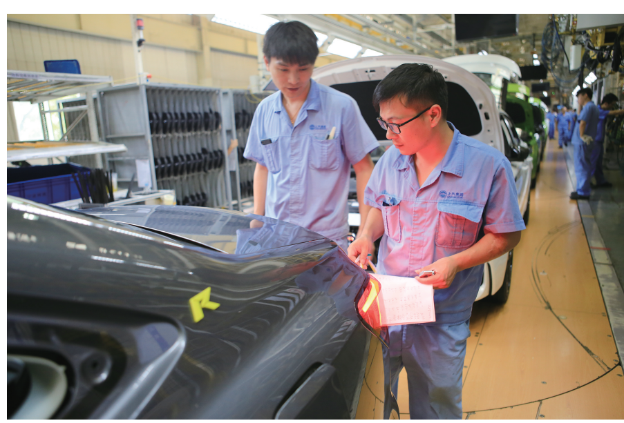
即将上市的天幕智能座驾荣威i6 MAX目前正在南京基地总装生产线上进行批量投产前的试装，工程技术人员与装配人员正在检校试装结果 图供 吴文娟
