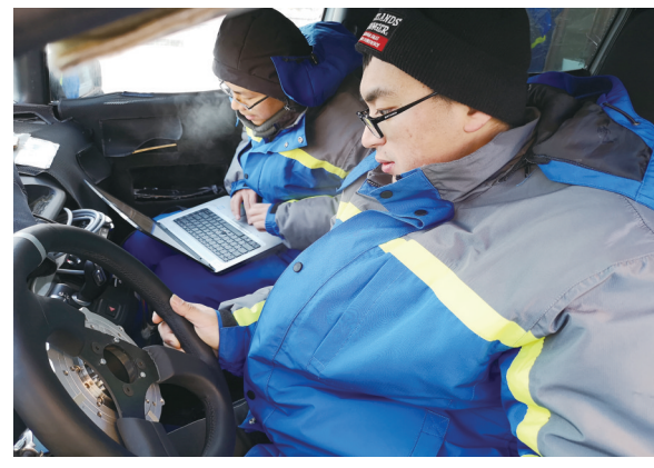
-30℃的海拉尔试验基地为车辆试验提供了天然条件。每年冬季，转向系统科都会有一群逆行者奔赴该地开展极寒条件下转向系统性能和可靠性实车测试，通过反复分析、验证和标定，确保产品质量合格 摄影 翁辉
