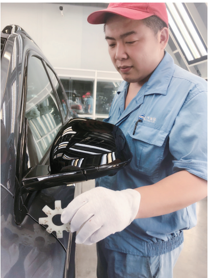
临港基地整车质保科CARE报交班组检验员正在测量前门与翼子板的匹配缝隙，每班累计检查近470辆整车的匹配度，靠的就是手中的“法轮盘” 摄影 张森臣
