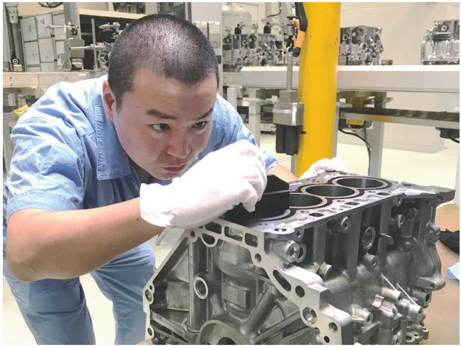
SGE发动机缸体在每一道工序加工完成后，都要有相应的检测，以保证尺寸的合格。即使工厂再嘈杂，匠人的内心必须是安静、安定的 摄影 李晓东
