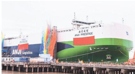
12月23日，上汽集团委托江南造船建造的远洋汽车运输船（滚装船）完成交付，并正式定名为“安吉威信”号。这艘远洋巨轮拥有7800车位，采用LNG双燃料清洁动力，计划首航欧洲后投入美墨航线。
